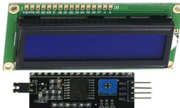
Рис. 17. Дисплей (жидкокристаллический индикатор — ЖКИ 16×2)
