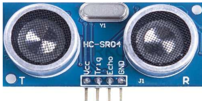
Рис. 16. Ультразвуковой датчик (дальномер)
