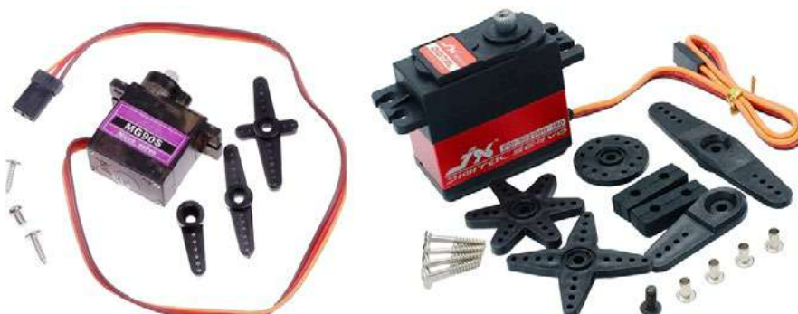
Рис. 19. Серводвигатели MG90S и PDI-6221MG-180
